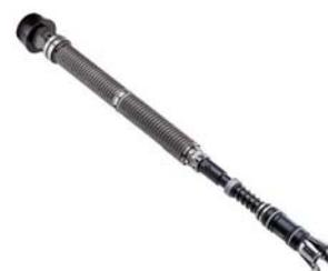
Dispositivo di misurazione della forza di bloccaggio
