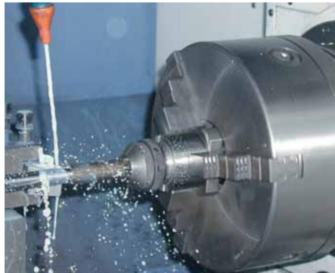
T.F. 13/25 montato su bussola di riduzione da cilindrico a cono morse con presa su autocentrante
